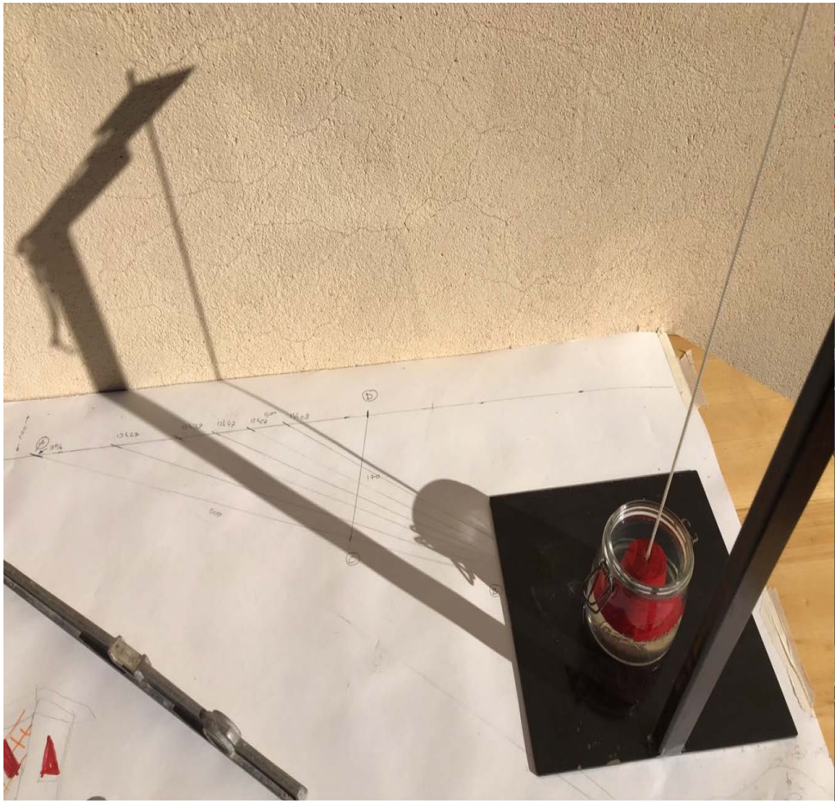
PY 3.14 : repérages empiriques de projection de la lumière mur ouest.
